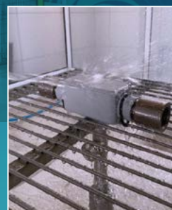
Teste do Grau de Proteção IP54
